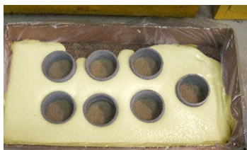
PedFloor s'écoule et entre en expansion au bout de 20 minutes
