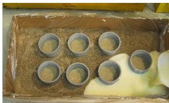
PedFloor est mélangé, puis versé.
