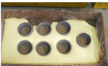
InstaGrout scorre e si espande dopo 20 minuti
