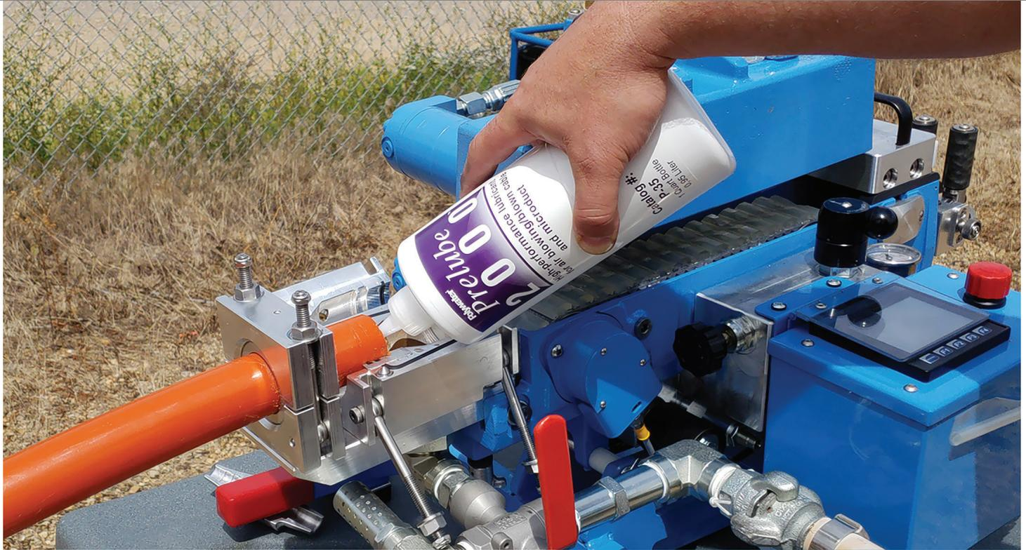
Aumenta la distancia de Instalaciones de Cables Fibra Óptica y Microductos
