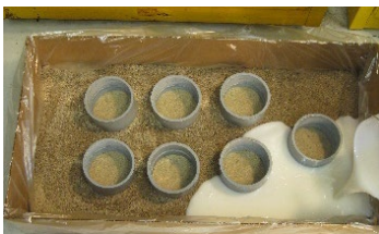
InstaGrout wird gemischt und gegossen
