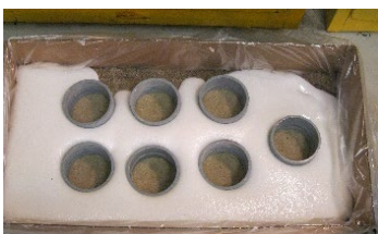
InstaGrout fließt und dehnt sich nach 20 Minuten aus
