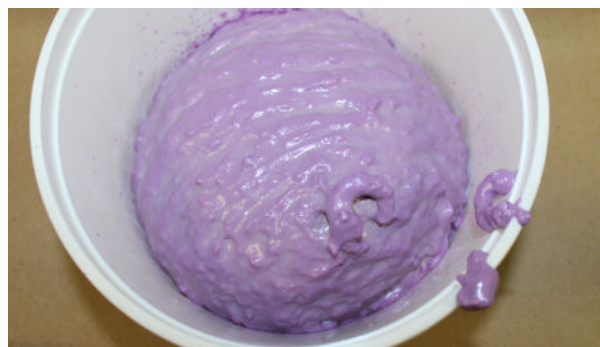
Foto 16 : Polywater AFT troppo caldo. Polimerizzato rapidamente.
