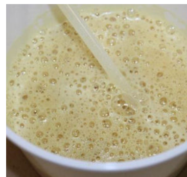
Foto 7 : bomboletta tenuta in posizione verticale. La seconda parte fuoriesce di colore bianco. Solo il componente A.
