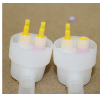
Foto 10 : ugello integro a sinistra. Ugello danneggiato a destra.
