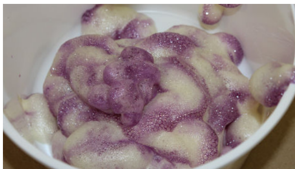
Foto 15 : Polywater AFT troppo freddo. Non miscelato correttamente.
