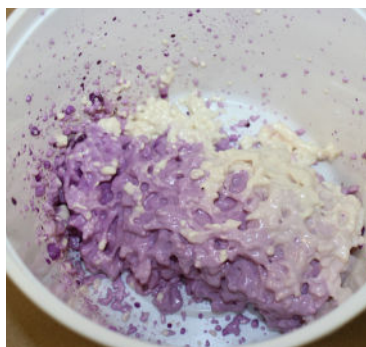
Foto 6 : bomboletta tenuta in posizione verticale. La prima parte di Polywater AFT fuoriesce di colore viola ma non è miscelata correttamente.
