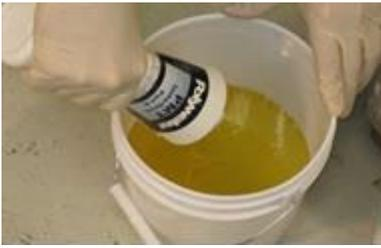
Versare 1 flacone di componente A, quindi 1 flacone di componente B nel secchio di miscelazione
