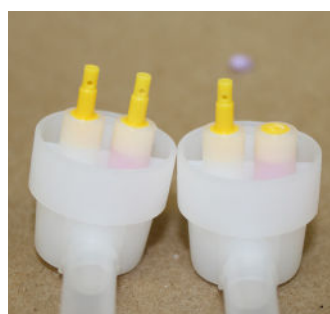
Photo 10 : Buse fonctionnelle à gauche. Buse cassée à droite.
