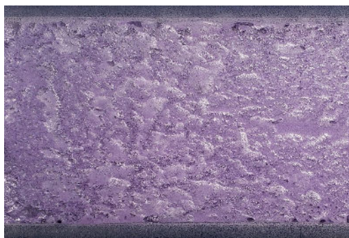
Photo 1 : Coupe transversale d'AFT durci dans une conduite. Noter la petite taille des pores.
