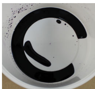
Photo 9 : Partie B agent de durcissement violet foncé uniquement. Partie A obstruée ou insert cassé.
