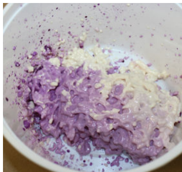
Photo 6 : Bombe aérosol tenue à l'endroit. La première partie de l'AFT sort violette, mais pas bien mélangée.
