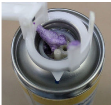
Photo 12 : Mousse bloquée expulsée sur le dessus de la bombe aérosol.
