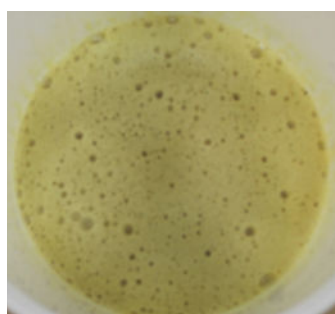
Photo 8 : Beige crémeux Résine de la partie A uniquement, partie B obstruée ou insert cassé.
