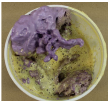
Photo 5 : Bombe aérosol tenue à l'endroit. L' AFT est mal mélangé. La bombe a été entièrement distribuée.
