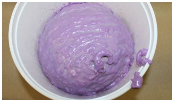
Photo 16 : Polywater AFT trop chaud. Durcit rapidement.
