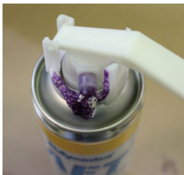
Photo 13 : Tige bouchée la buse enlevée.
