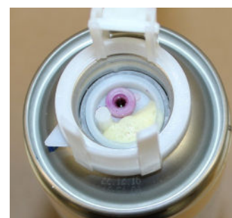
Photo 11 : Ouverture de la bombe aérosol obstruée.
