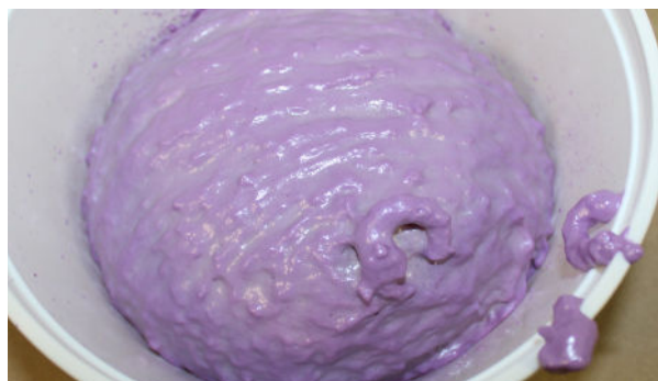
Photo 2 : Polywater AFT durci laissé en expansion libre, dans un seau.
