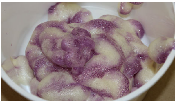
Photo 15 : Polywater AFT trop froid. Ne s'est pas mélangé.
