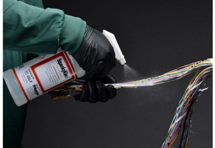
SqueeKleen limpia y despliega las fibras en dos pasadas
