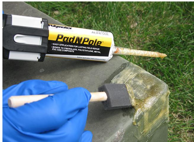
Le produit Polywater Pad N Pole est utilisé pour réparer les boîtiers endommagés.
