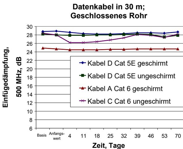
Polywater FTTx zeichnet sich durch eine drastische Verringerung der Reibung bei Datenkabel-Installationen aus. Datenkabel wurde durch EMT-Rohr gezogen, mit zwei 90°-Krümmungen und einer Abwicklungsspannung von 6,35 kg.
