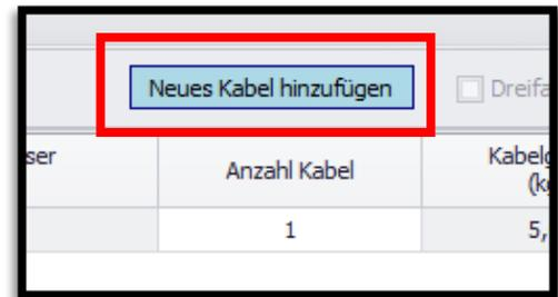
Sie können ein Kabel aus der Datenbank auswählen, indem Sie die Dropdown-Liste verwenden, oder Ihren eigenen Kabel-Außendurchmesser, sein Gewicht und die Anzahl der Kabel eingeben. Die Eingabe des Außendurchmessers muss in Millimetern (metrisch) oder Zoll (englisch) erfolgen und wird auf 2 Dezimalstellen (metrisch) bzw. 3 Dezimalstellen (englisch) gerundet. Die Gewichtsangaben müssen in kg/m (metrisch) oder lbs/ft (englisch) erfolgen und werden auf drei Dezimalstellen gerundet.
