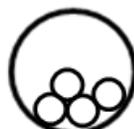
4 Kabel, raute-förmig:  $D/d < 3,0$       4 Kabel, liegend:  $D/d \geq 3,0$
