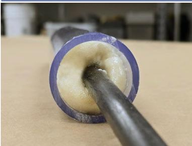
8. ZipSeal s'étend entièrement en environ 1 minute et durcit en 2 minutes. Inspecter le joint pour détecter tout écart visible. Ceux-ci peuvent être remplis avec du ZipSeal supplémentaire.
