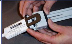
4. Pousser le collier vers l'arrière et appuyer fermement pour qu'il se clipse en place.
