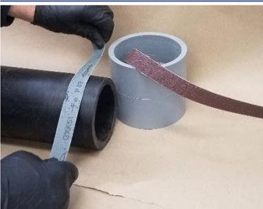
Rohr und Kupplung schleifen
