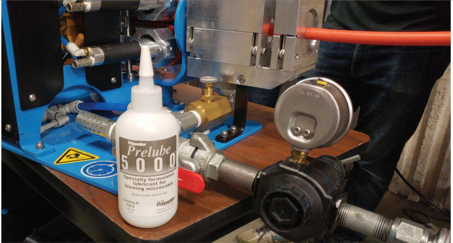
Aumenta la Distancia de Instalación al Soplar los Microcables de Fibra Óptica
