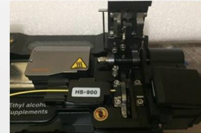
3. Pele las fibras. Asegure las fibras con sujetadores o soportes e insértelas en la ranura en V. No toque ni limpie la superficie pelada
