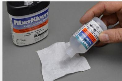
2. Coloque 1 o 2 gotas de Polywater AquaKleen en una toalla, al menos ½ pulgada (13 mm) del borde. Cree un área húmeda de aproximadamente ½ pulgada (13 mm) de diámetro.
