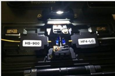
4. Repita los pasos del 1 al 3 para el segundo extremo de fibra (ya sea el cable o el conector). Asegure el cable de fibra de óptica e insértelo en la ranura en V opuesta.
